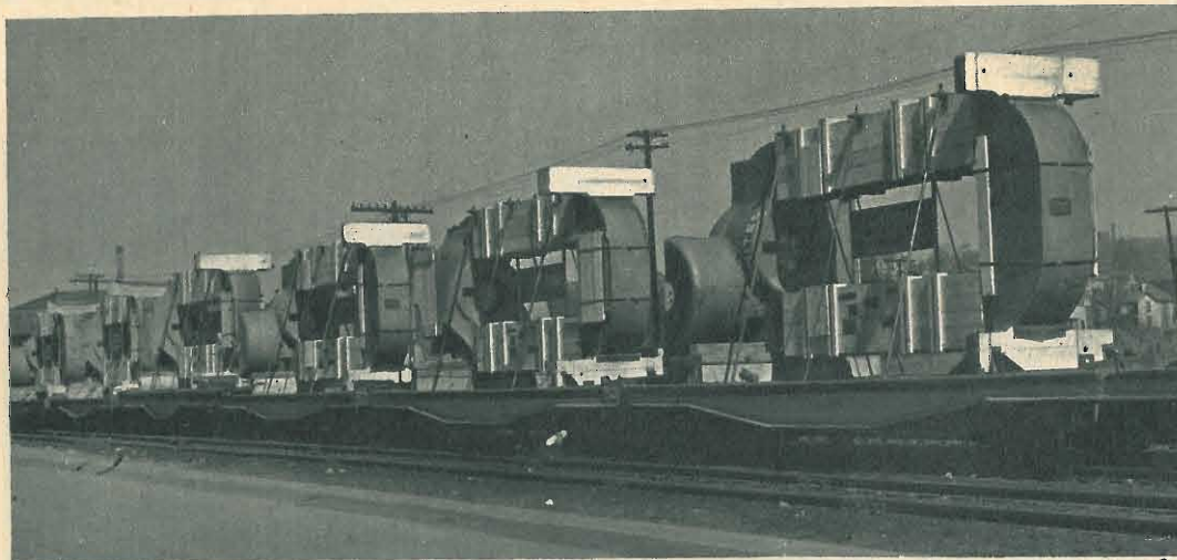
• Su carri ferroviari speciali s'inizia il viaggio dei basamenti delle gabbie di laminatoi fabbricati a Pittsburg e destinati ad uno stabilimento siderurgico europeo. Poichè la rigidità di questi ba-
