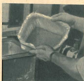
• Impregnata con una resina adatta, la preforma è posta in uno stampo dove avviene la cottura, in condizioni che dipendono dal tipo di resina adoperata.
