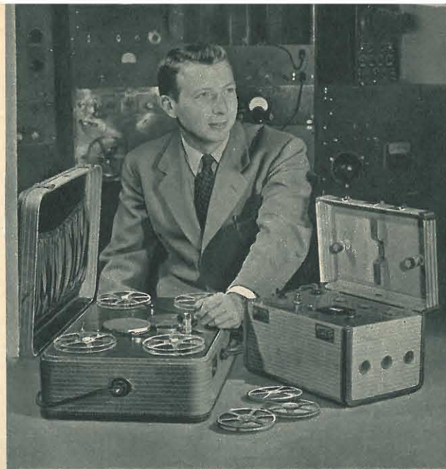
• L'apparecchio dimostrativo a testa di registrazione unica (velocità 6 m/sec) consta di due valigie.
