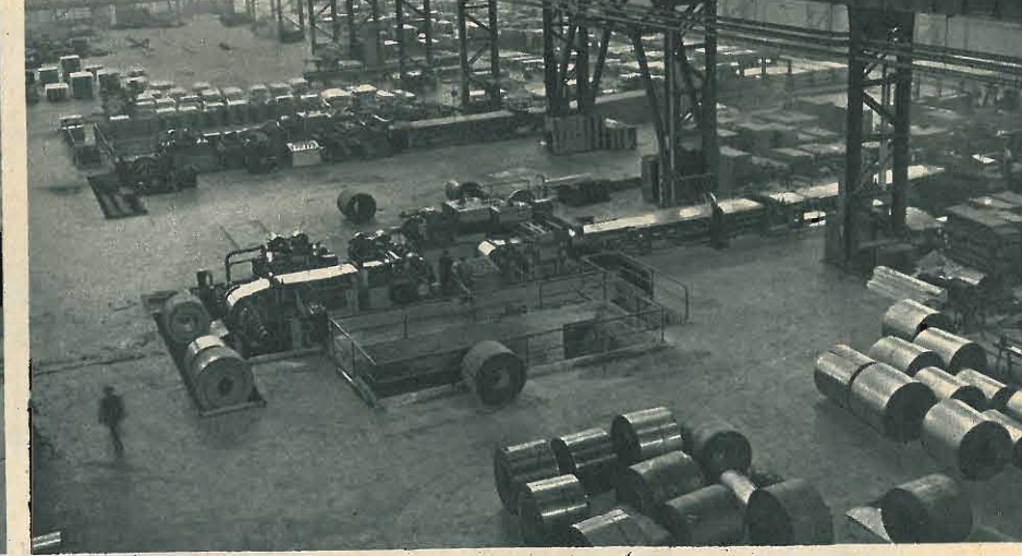
6 Nel reparto taglio, la lamiera viene ritagliata nelle lunghezze commerciali volute, eventualmente rinfilata agli orli mediante speciali cesoie, poi riavvolta.
