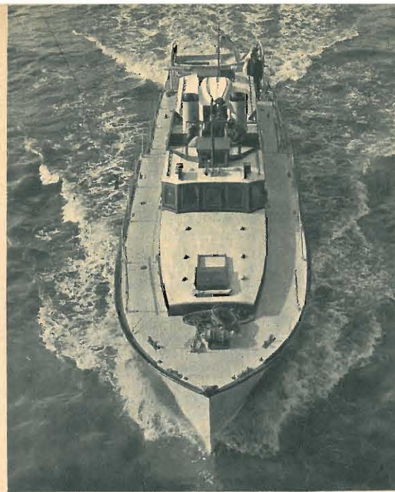
• Questa nave, costruita a scopo sperimentale sotto il controllo dell'Ammiragliato britannico, è mossa da due turbine Rover. Il forte consumo di carburante può essere compensato dalla leggerezza del motore (200 kg) e dal suo piccolo ingombro (lunghezza 120 cm, altezza e larghezza 75 cm).
